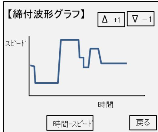
締付波形は「横軸: 時間ー縦軸: トルク」、「横軸: 時間ー縦軸: スピード」、「横軸: 角度ー縦軸: トルク」、「横軸: 角度ー縦軸: スピード」のグラフが見れます。
