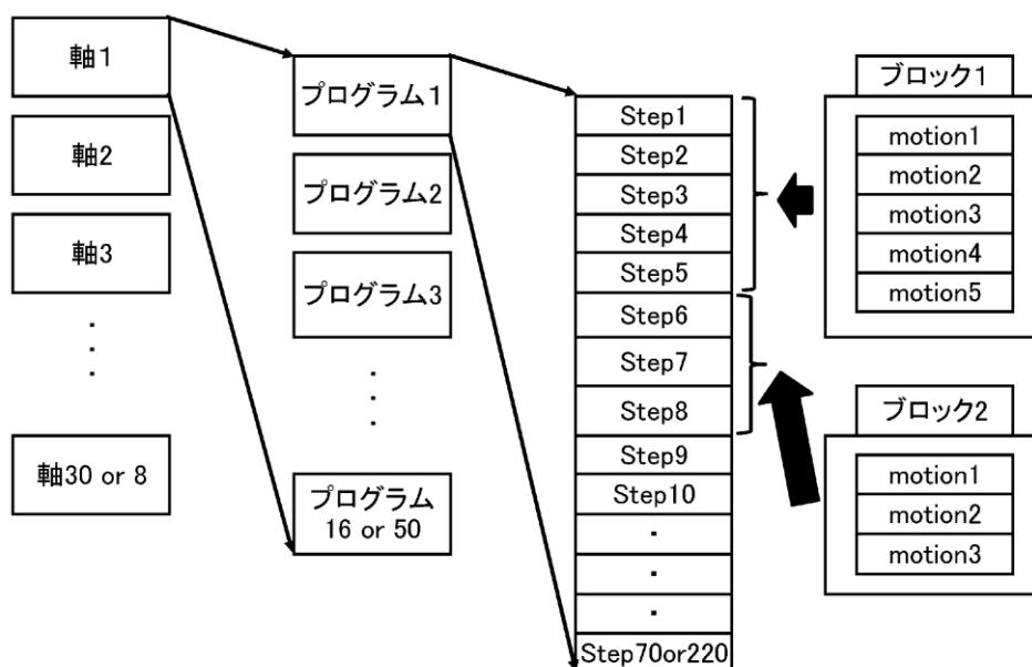
締付パラメータ設定(上図右のブロックで設定するmotionにてこの設定を使用)
