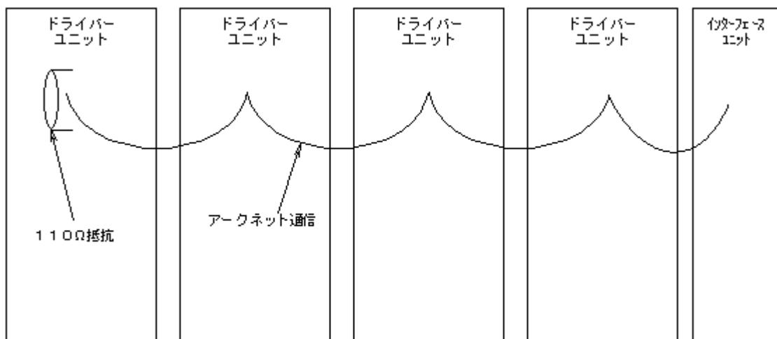
アークネット接続の終端ユニットの(+)(-)に、110Ωの抵抗を実装してください。
