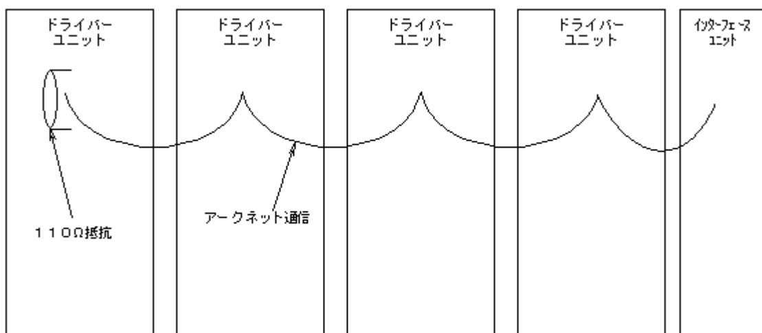
アークネット接続の終端ユニットの(+)(-)に、 $110\Omega$ の抵抗を実装してください。
